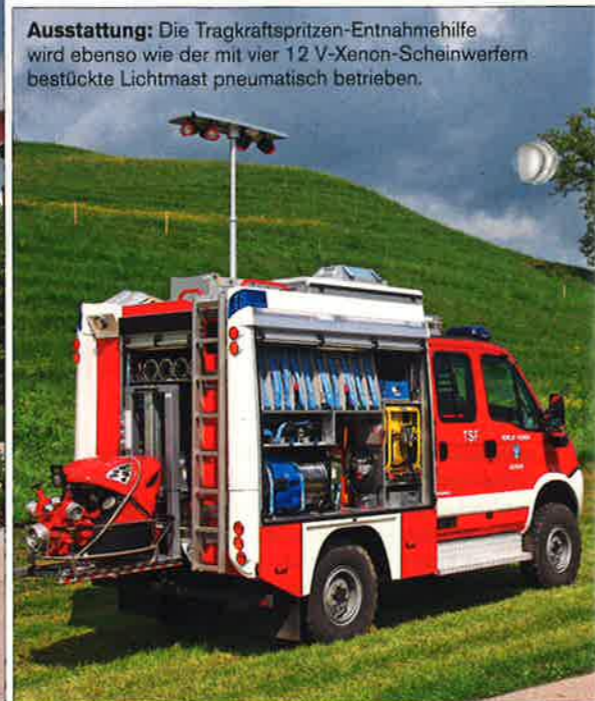
Allrad-TSF: Auf einem IVECO Daily-Fahrgestell des Typs 65 S 18 W ist das im Werk Graz der IVECO Magirus Brandschutztechnik GmbH gefertigte TSF aufgebaut.
