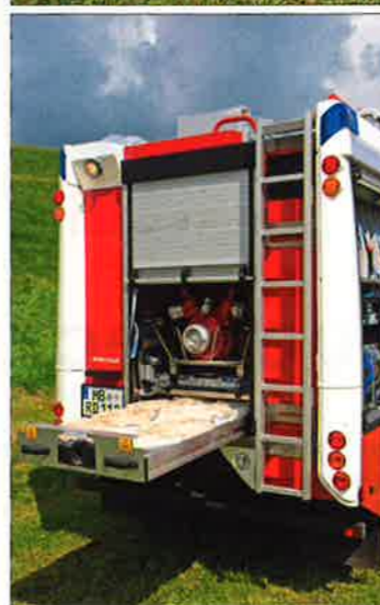
Wasser-versorgung: Unter der Tragkraftspritze ist eine Schublade angeordnet, in der neun fest gekuppelte B-Druckschläuche transportiert werden.
