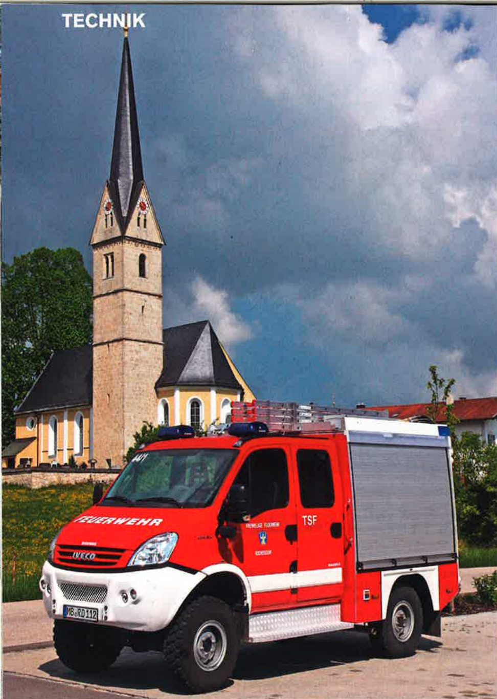
Allrad-TSF: Auf einem IVECO Daily-Fahrgestell des Typs 65 S 18 W ist das im Werk Graz der IVECO Magirus Brandschutztechnik GmbH gefertigte TSF aufgebaut.
