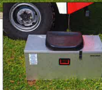
Maschinen-Box: Gut zu erkennen ist die sogenannte „Maschinen-Box“, in der die zur Wasserentnahme mit der TS notwendigen Armaturen mitgeführt werden.
