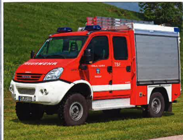
Allrad-TSF: Auf einem IVECO Daily-Fahrgestell des Typs 65 S 18 W ist das im Werk Graz der IVECO Magirus Brandschutztechnik GmbH gefertigte TSF aufgebaut.
