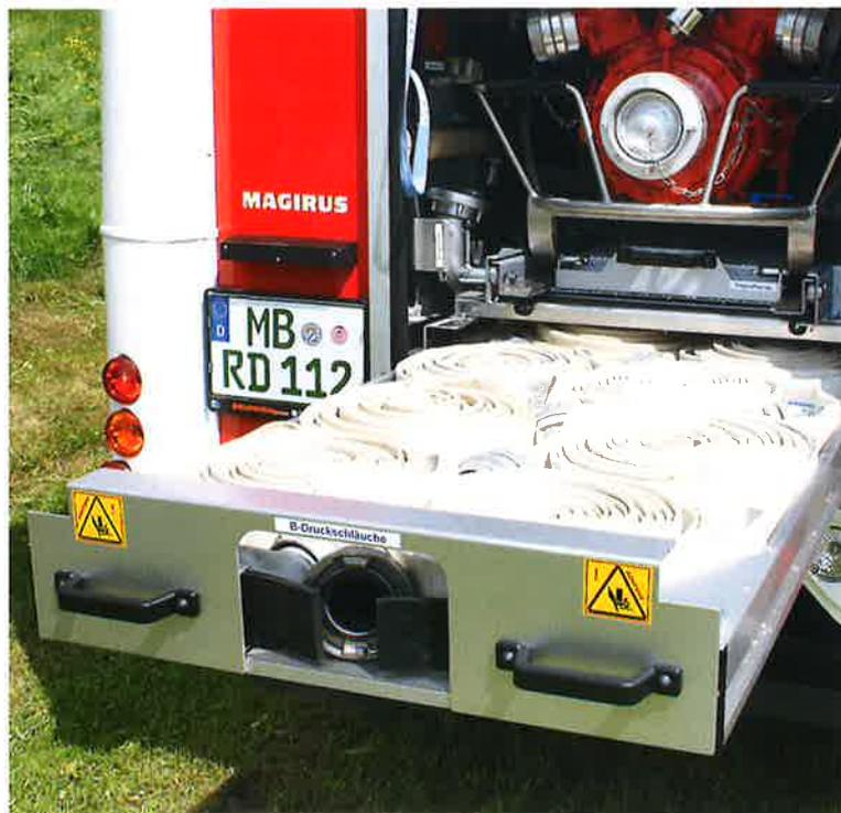
Neun gerollte B-Schläuche liegen zusammengekuppelt im Heck unterhalb der Tragkraftspritze TS 8/8 und können zum Aufbau einer Wasserversorgung bei langsame Fahrt ausgelegt werden. Zum Bestücken mit neuen Schläuchen lässt sich die Schublade herausziehen.
