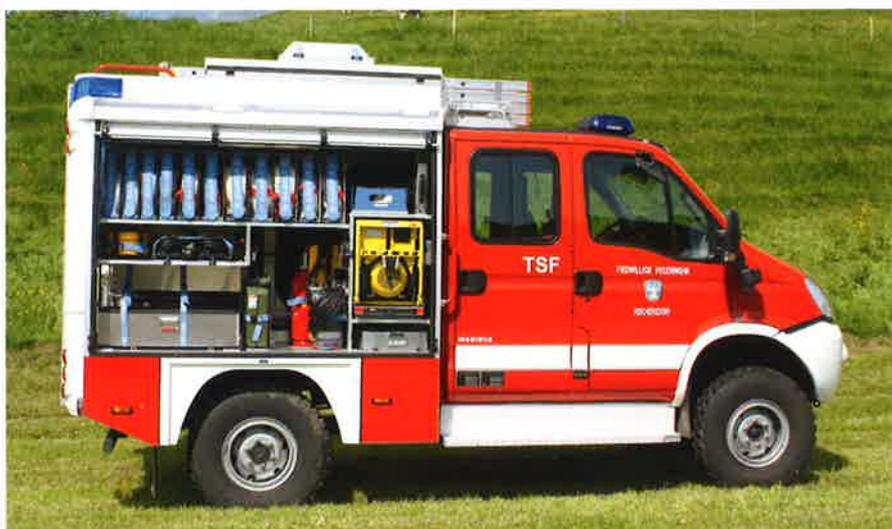
Sechs C- und fünf B-Schläuche, zwei 1000 Watt-Scheinwerfer mit Leitungsroller, HiPress-Löschler und Tauchpumpe stellen die Schwerpunkte der Beladung auf der rechten Fahrzeugseite dar. Links unten ist Platz für eine leere Transportkiste oder einen Wassersauger. Auf dem Auszug hinter dem 6-kVA-Stromerzeuger befindet sich Ölbindemittel.
