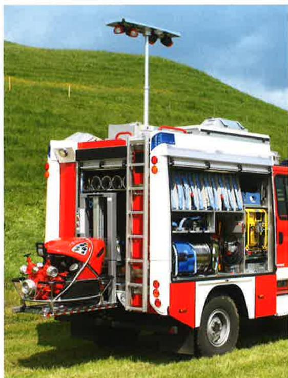
Die TS 8/8 lässt sich auf einem herausziehbaren Schlitten zur Entnahme absenken. Darüber lagern vier Saugschläuche. Vier Xenonscheinwerfer am Lichtmast sorgen für Ausleuchtung des Fahrzeugumfeldes und der Einsatzstelle.
