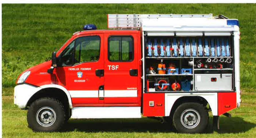
Drei C- und elf B-Schläuche nehmen den oberen Teil des Geräteraumes auf der linken Seite ein. Darunter liegen Motorkettensäge mit Zubehör und Schnittschutzkleidung, wasserführende Armaturen, Strahlrohre, Pulverlöschler, Verkehrsabsicherung und ein Werkzeugkasten. Alle für die Bedienung der TS 8/8 benötigten Geräte sind griffbereit in der herausnehmbaren Kiste verstaut.
